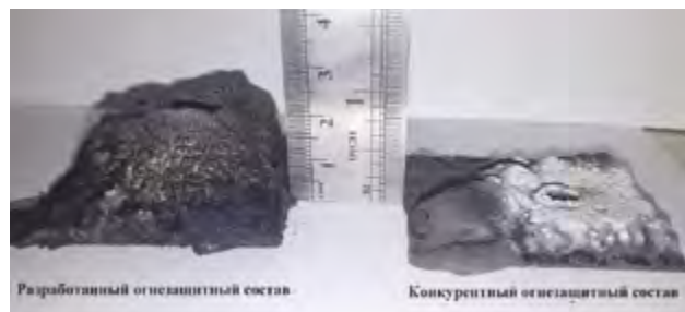
Вспененный кокс, образующийся под воздействием пламени. Сравнение разработанного образца с конкурентным огнезащитным составом.
